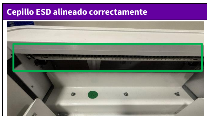
Figura 1: Cepillo ESD alineado correctamente
